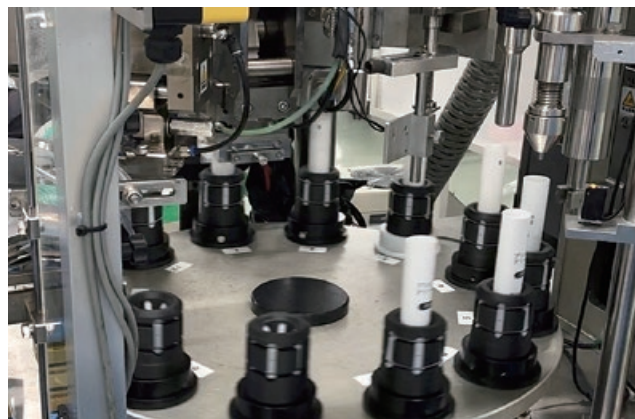
MARK TWOで造形した製造用治具の例。左から、チューブ充填用ホルダーの造形過程。ホルダーにチューブをセットした状態
